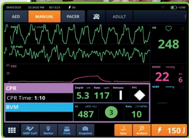
Echtzeit-Feedback zur Beatmung auf dem Bildschirm und farbliche Anzeige auf dem Atemwegssystem
